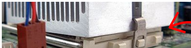
Ligar o micro com o cooler instalado desta maneira, equivale a ligá-lo sem o cooler.
